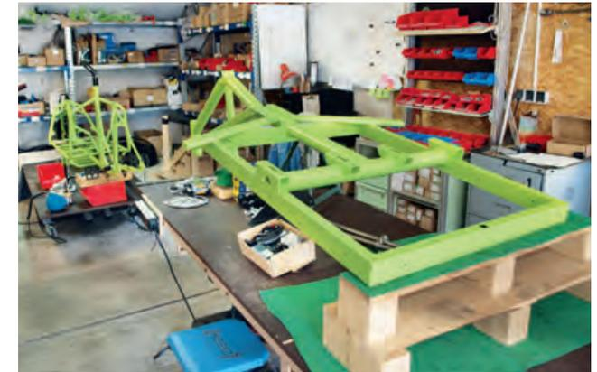
**Abbildung 21:** Fertigung eines Lastenrades<sup>139</sup>
